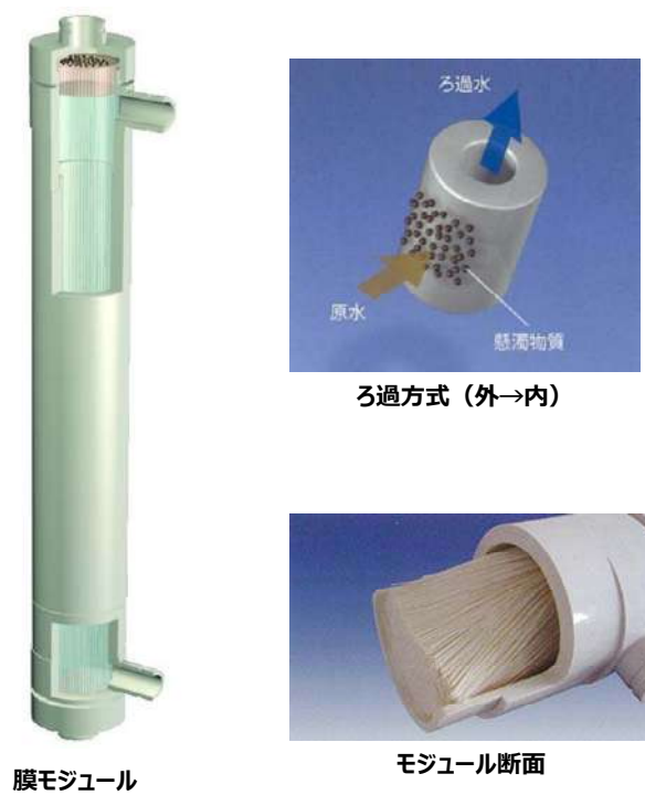
図 2-6 UF 膜モジュールの概要
