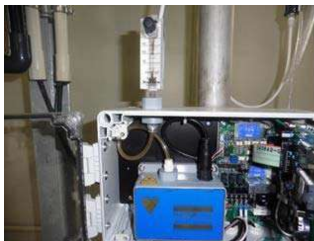
図 7-3 高感度濁度計の配管チューブ内のスケール発生状況
