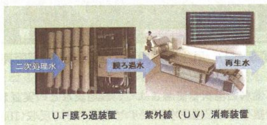
図-4 再生水の処理システム
