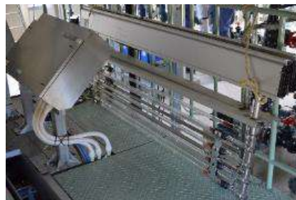
左：UF 膜ユニットの様子 中：UV 消毒機器の様子 右：プラント内はすべて電気で制御される 出所）筆者撮影
